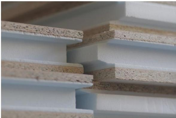
**Figura 3:** *Espuma de Poliestireno Extruido*
