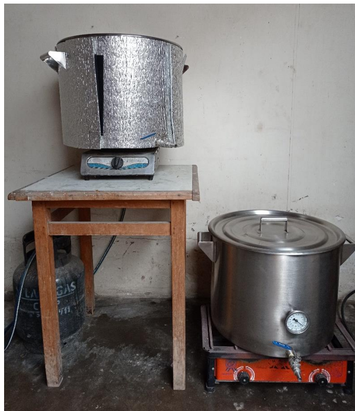
Equipos de maceración y cocción
